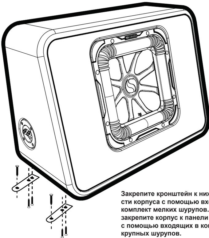
Закрепите кронштейн к нижней части корпуса с помощью входящих в комплект мелких шурупов. Надежно закрепите корпус к панели автомобиля с помощью входящих в комплект более крупных шурупов.
