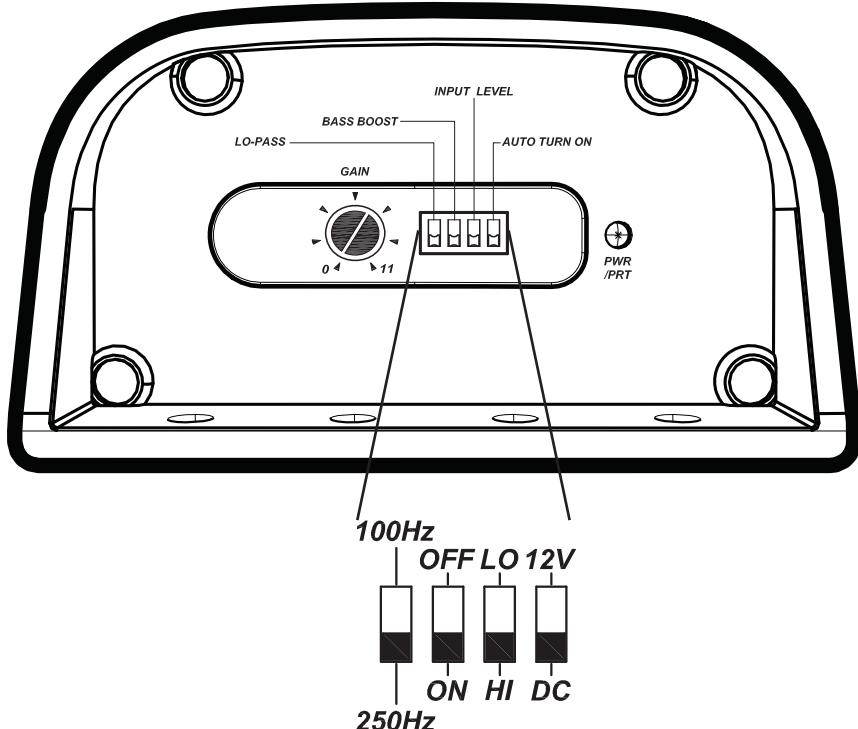
**Регулятор Automatic Turn-On:** Усилитель серии PX позволяет воспользоваться двумя режимами автоматического включения, которые можно выбрать на боковой панели: +12V и DC Offset. При выборе режима DC Offset через разъем REM будет подаваться выходной сигнал +12 В для включения дополнительных усилителей.
