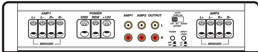
**Регулятор Automatic Turn-On:** Усилители серии IX позволяют воспользоваться тремя режимами автоматического включения, которые можно выбрать на задней панели: +12V, DC Offset и Audio. При выборе режима DC Offset или Audio через разъем REM будет подаваться выходной сигнал +12 В для включения дополнительных усилителей.
