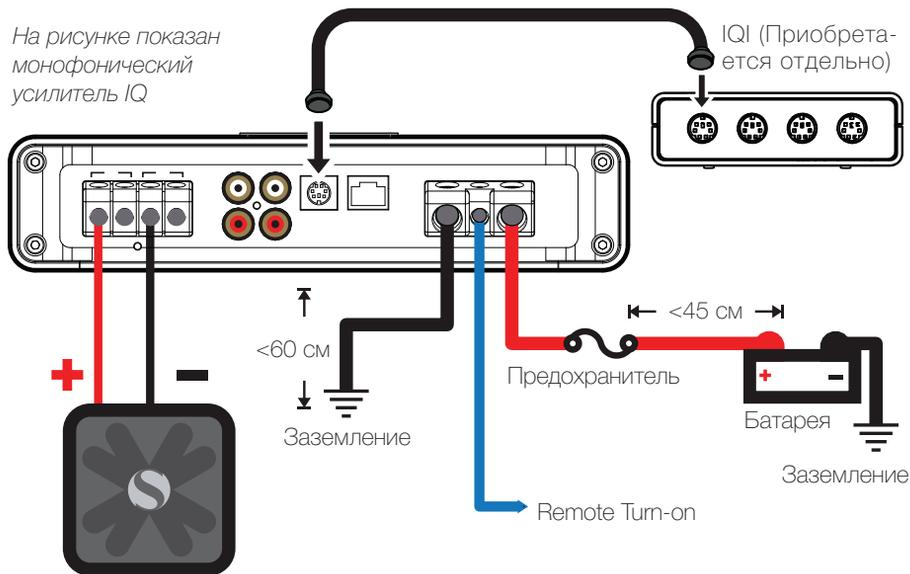
Подключите акустическую систему к усилителю IQ с помощью кабеля диаметром 16GA или более. Подключите выход источника сигнала к RCA входам IQ усилителя. Используйте выходы RCA усилителя IQ для передачи сигнала устройства на другой усилитель.
